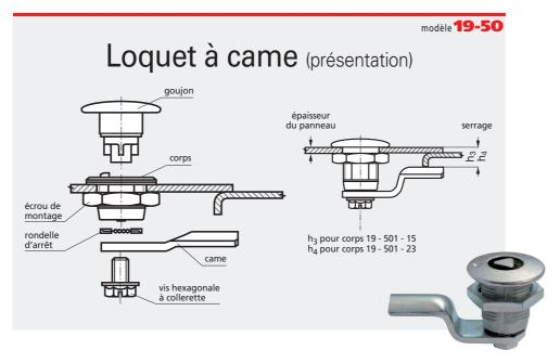
Un loquet à came modulable complet se compose d'un corps (19-501 page I 14), d'un goujon (19-503 page I 15) et d'une came plate (19-507 page I 16), à commander séparemment. Le loquet à came modulable peut s'assembler avant montage pour utilisation dans des panneaux inférieurs à 6 mm.
